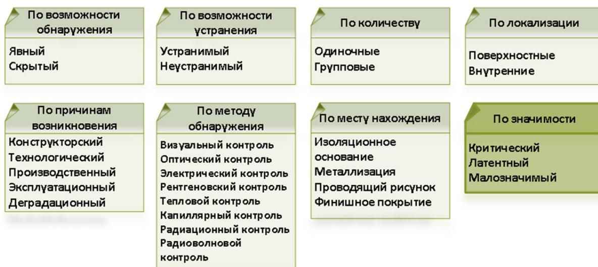
Рис. 3. Фасетная классификация технологических дефектов печатных плат
